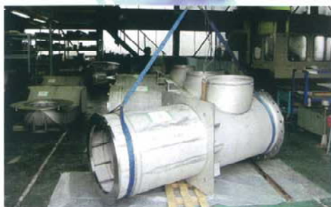
SUS製ポンプ設備
