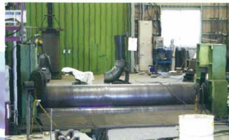
4m幅、最大板厚110mmまでの曲げ加工可能
